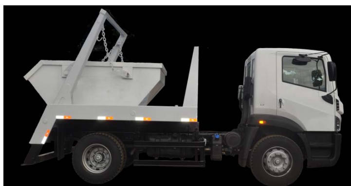
Figura 2- Poliguindaste transporta caçamba
