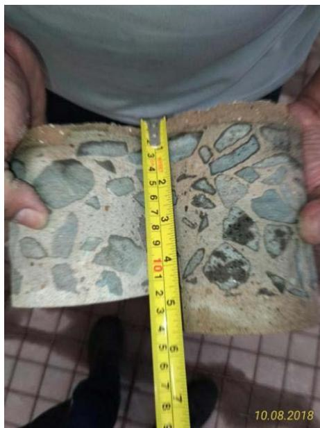
Note que o resultado do rompimento do corpo de prova cilíndrico pelo método do ensaio da ABNT NBR 5739, obteve-se resultados também inferior ao recomendado pela ABNT NBR 6118, ou seja, inferior 20 MPa.
